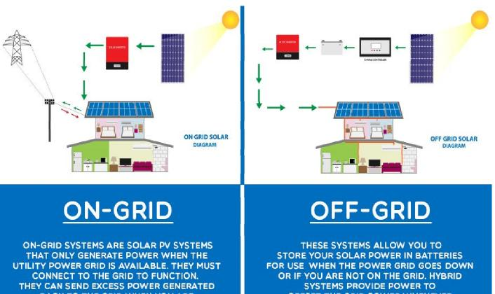
THEY CAN SEND EXCESS POWER GENERATED BACK TO THE GRID WHEN YOU ARE OVERPRODUCING SO YOU CREDIT IT FOR LATER USE. OR IF YOU ARE NOT ON THE GRID. HYBRID SYSTEMS PROVIDE POWER TO OFFSET THE GRID POWER WHENEVER THE SUN IS SHINING AND WILL EVEN SEND EXCESS POWER TO THE GRID FOR CREDIT FOR LATER USE.
